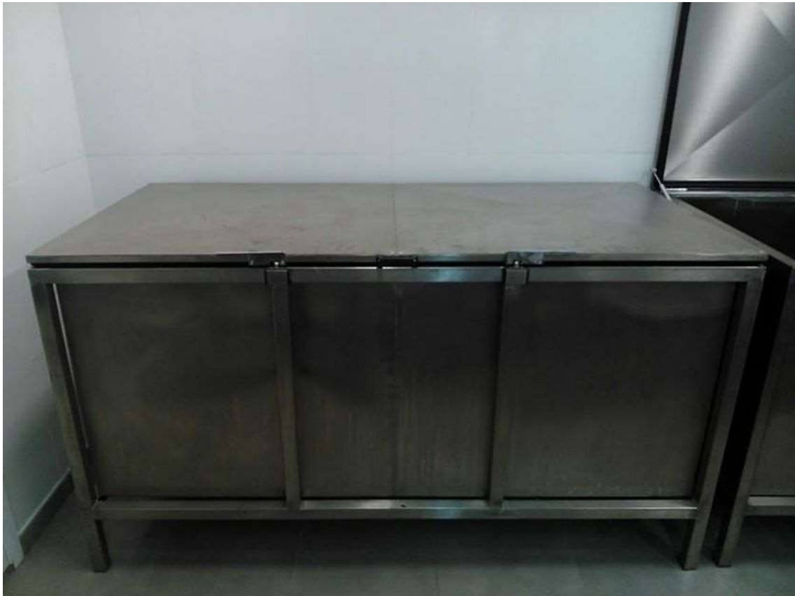
FIGURA 6 - QUATRO PERNAS REFORÇADAS PARA SUSTENTAÇÃO, NOS QUATRO CANTOS DO TANQUE.
