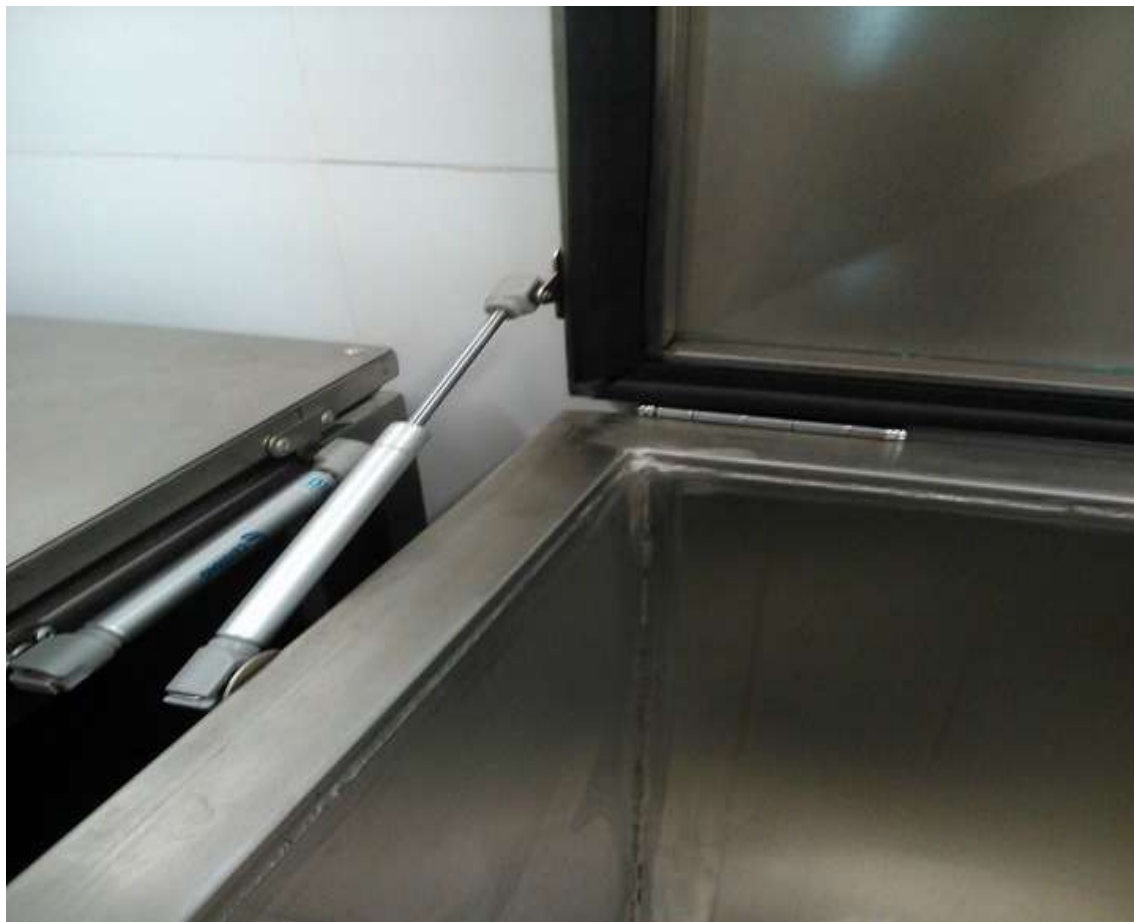
FIGURA 4 - CILINDROS HIDRÁULICOS LATERAIS (TIPO LEVANTAMENTO AUTOMÁTICO) PARA A TAMPA, UM EM CADA LADO DO TANQUE, PROPORCIONANDO DIMINUIÇÃO DA FORÇA GRAVITACIONAL DURANTE A ABERTURA E FECHAMENTO DO TANQUE.
